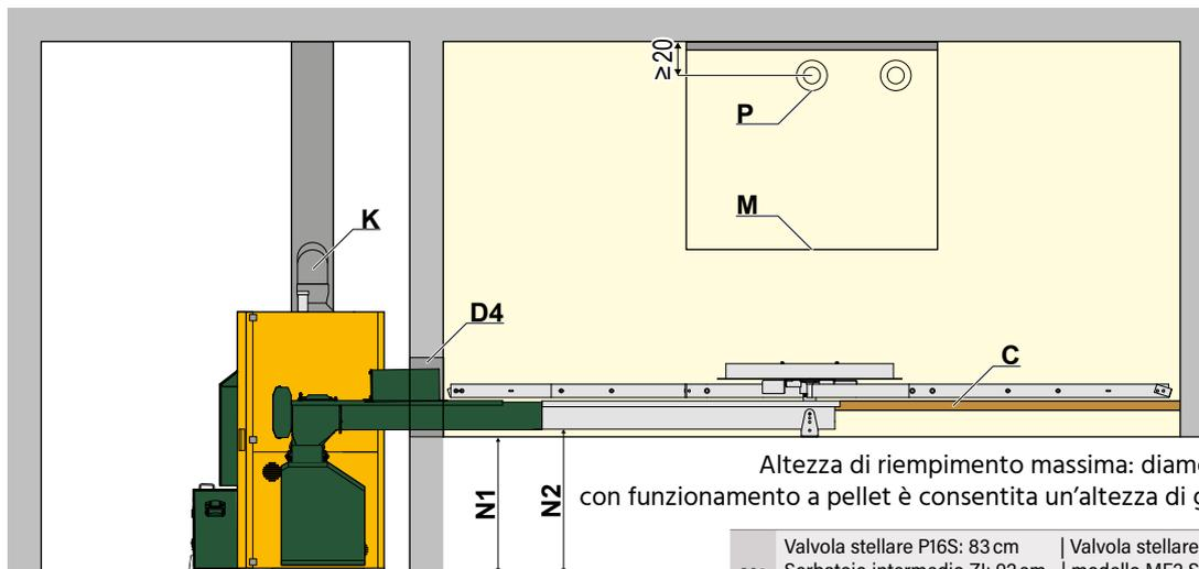
Altezza di riempimento massima: diametro agitatore x 1,5; con funzionamento a pellet è consentita un'altezza di gettata max. di 3 m.
